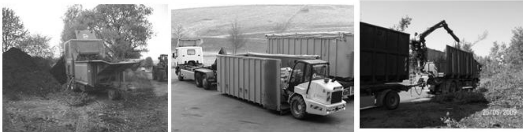
Abb. 2: Geprüfte Erfassungssysteme: dezentrale Zerkleinerung, Radlader und Containerzug, Containerzug mit Greifarm
