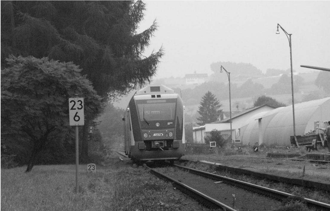
Abb. 16: Beeinträchtigung durch Gehölzwuchs im Schienenverkehr (Lichtprofil)
